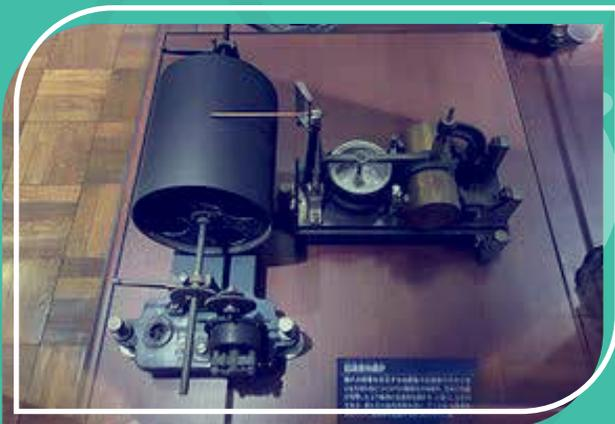
**(1914)** **L. Mintrop** desarrolla el primer sismógrafo mecánico de precisión para realizar la exploración.
