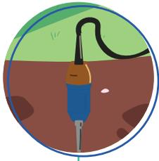
**Geófonos:** Son pequeños receptores ubicados de manera estratégica con el objetivo de que reciba las ondas sonoras emitidas por alguna fuente sísmica mediante unidades móviles (tipo vibros), cañones de aire comprimido o sismigel. De esta manera obtenemos la información del subsuelo.
